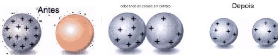
Figura 8 - Conservação de carga após contato entre corpos
